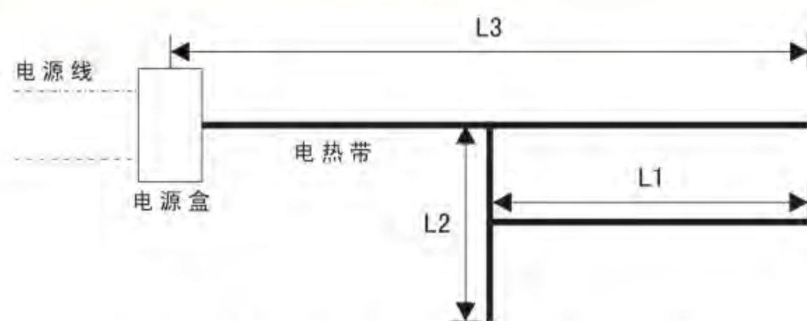
L1+L2+L3 \leq 最大电热带长度 ( L_{max} )
